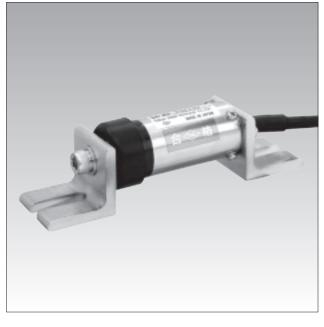
コンクリート表面のクラックや打継目にまたがせて表面の開口変位を測定する変位計です。防滴構造のため、長期にわたる屋外測定でも安定した測定が可能です。取付けにはアンカボルト(KGF-11)または取付コマ(KGF-31)を用います。
