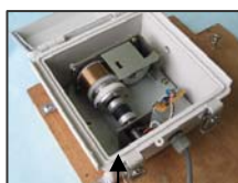
防水構造の内部機構
