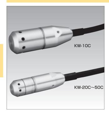
ダムや河川の水位測定はもとより、地滑り発生地帯の地盤内における 地下水位の変動を測定する水圧式の水位計です。大気圧の変動による 影響の補正を必要としない構造のため精度の高い測定が可能です。 (アレスタ内蔵)
